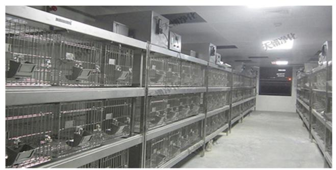
动物实验室设计的布局要求(1)动物实验室的屏障环境强调人流、物流、动物流分开,并循单向路线流动,清污分流,做到净化、防虫,人员进入动物房要洗澡、更衣后进入清洁走廊,由清洁走廊再进入饲育室或实验室,然后循污物走廊出去(2)进行动物实验室区域的要求:清洁物经脱外包装后进入洗刷间清洗,通过双扉高压消毒柜消毒,而不能高压消毒的物品必须经传递舱或渡槽进入,清洁物品首先储藏于清洁物品储藏间,再由清洁走廊到达每一个饲育室或实验室。当然,每个动物实验室的研究属性不同而设计的要求也有所不同,但动物实验室的在总体规划设计时应认真考量以上方面。张家界专业施工动物房专业设计团队认真做好实验动物房的屏障环境内外的清洁消毒工作。
