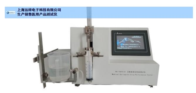
YL-C医疗器械流量测试仪采用5.7英寸(120×90)单彩液晶触摸显示屏,中文菜单显示。并由键盘进行选择,并可由机载打印机打印出测试结果。医疗器械流量测试仪是依据医疗器械国家标准中的有关条款而设计的专门用于检测医疗器械流量的设备。
