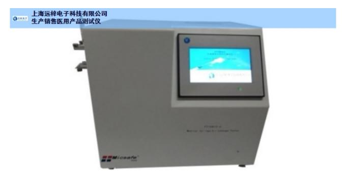
LL0285-A 导管流量测试仪采用5.7英寸(120\*90)液晶触控屏,中文菜单显示□AD采集速度为500KHz□内码50万;高精度时钟芯片,断电存储□PLC控制;过载报警停机保护;公称规格、打印、测试、时间。由键盘控制液晶显示屏上的菜单,实时显示测量值、平均值,自动判别合格与否,自动输出数据报告,机载打印测试数据,可与上位微机通讯,用16位A/D转换器,称重法采集计算导管流量
